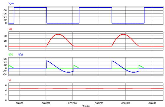
그림 2 시뮬레이션 파형 (게이트파형, 드레인소스전압, 다이오드전류 및 병렬캐패시터 전류, 출력DC전압)
